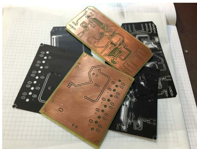
Slika 8: Izrađene tiskane pločice te filmovi korišteni u razvijanju
