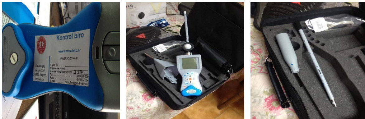
Slika 1. Digitalni ručni multifunkcijski instrument MetrelMultinorm MI 6201
