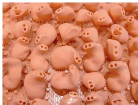
Slika 9. Zubni most (lijevo, izvor: GoetheLab FH Aachen/Sokalla), kućišta slušnih pomagala (desno, izvor: 3D Systems) [4]
